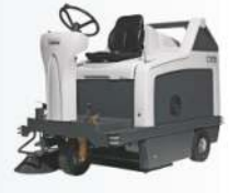
SR 1301 utilizat pentru curățare industrială cu posibilitate de basculare a gunoierului
